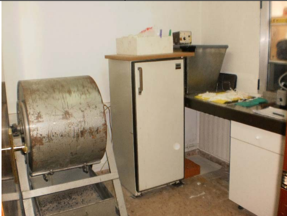
CUARTO AISLADO Y ACLIMATADO. MÁQUINA DESGASTE LOS ÁNGELES
