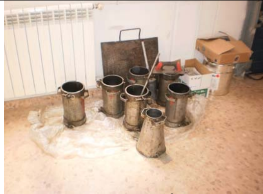
MOLDES HORMIGÓN Y CONO DE ABRAMS
