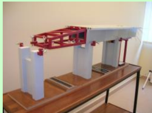
Puente con tablero empujado, durante el proceso de construcción
