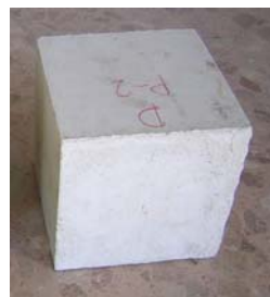
Dado de hormigón
