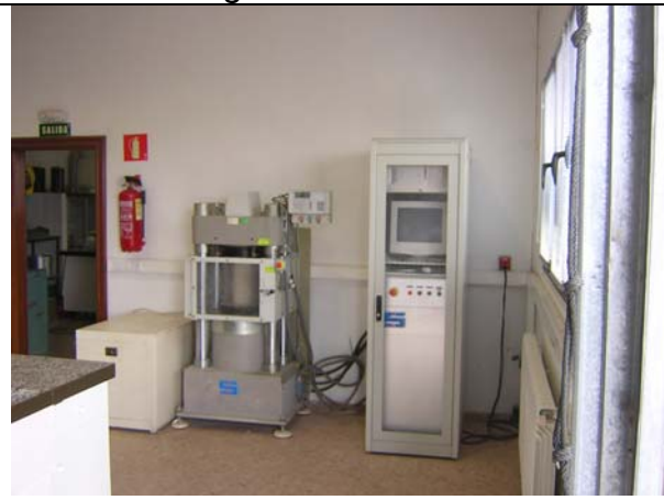
Prensa para romper probetas de hormigón
