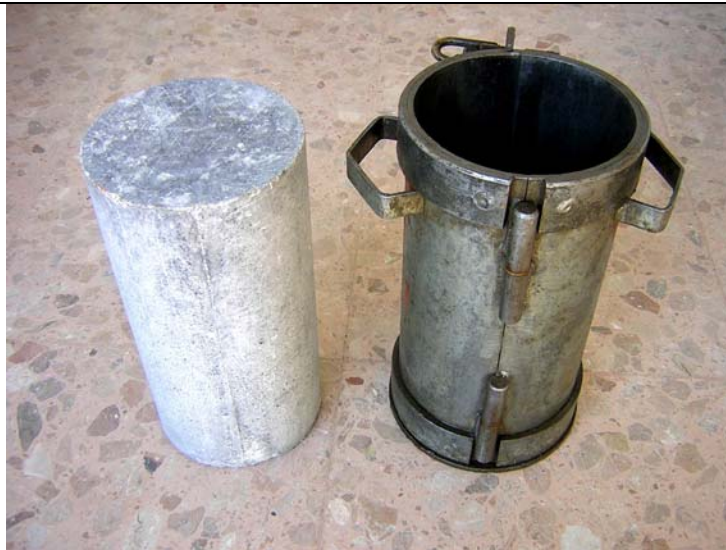
Molde y probeta cilíndrica de hormigón
