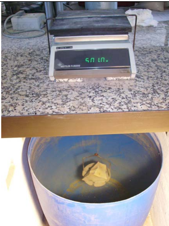
Pesada de la piedra sumergida en agua
