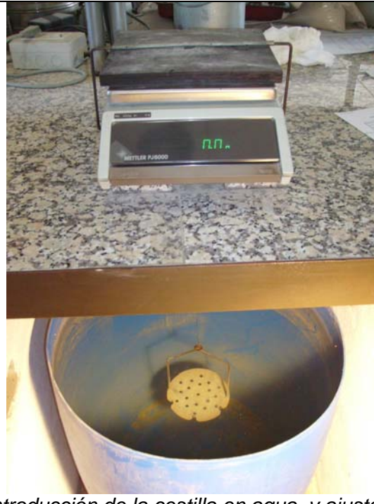
Introducción de la cestilla en agua, y ajuste a cero de la báscula
